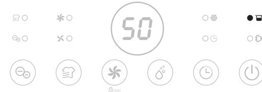
التوقف التلقائي مع مؤشر امتلاء الكامل لخزان المياه سيتخذ الجهاز وضعية الاستعداد عندما يكون خزان المياه ممتلئاً بشكل كامل أو ان لم يتم تثبيت الخزان بشكل صحيح. فبعد ان يتم تفريغ الخزان او تركيبه بطريقة صحيحة سيعاود الجهاز إلى وضعه السابق ويكمل عمله . زر التشغيل هو الوحيد من بين الأزرار الذي من الممكن أن يستجيب بوضعية امتلاء الخزان أو خلال تفريغه او عدم تركيبه بشكل صحيح.
